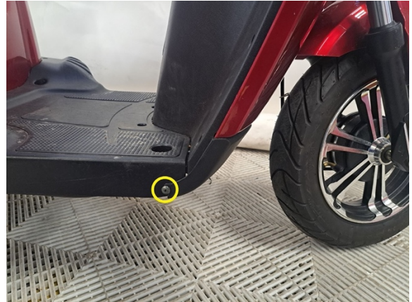
Irrota etukatteen alaosan kiinnitysruuvit (ristipäämeisseli ph2) kummaltakin puolelta.
